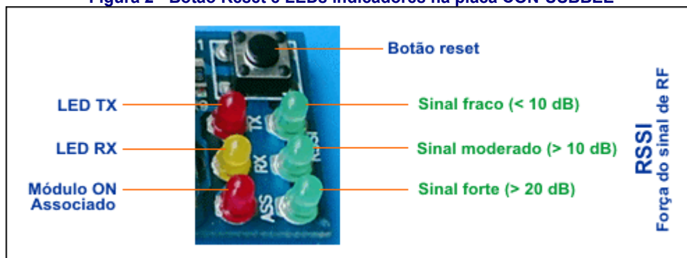
Figura 2 - Botão Reset e LEDs indicadores na placa CON-USBEE
